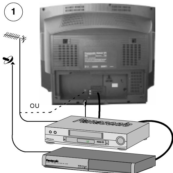
Raccordez l'antenne et branchez l'équipement auxiliaire.
